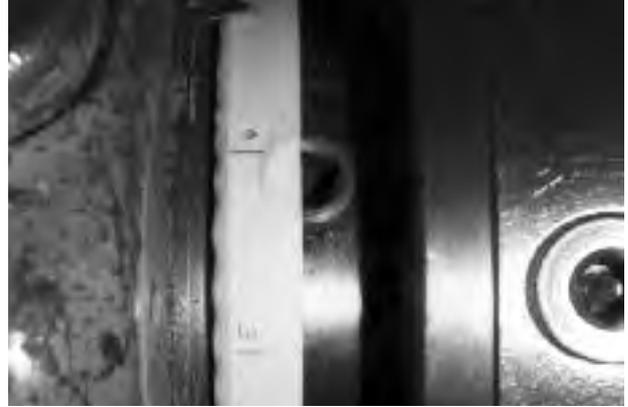
El diámetro exterior del plato de arrastre puede ser dividido y marcado actuando así como una guía para posicionar las ranuras en el cojinete.
