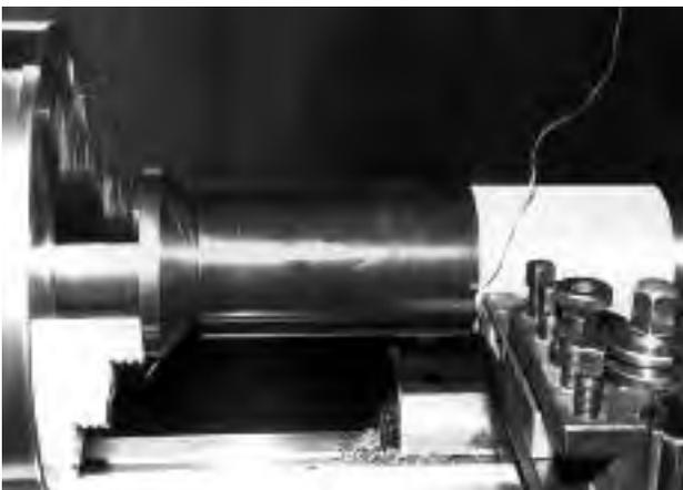
Una vez se ha mecanizado el I.D. del cojinete con ranuras de lubricación éste puede ser sujetado entre centros, guiado por una chaveta en una de las ranuras y se efectúa el mecanizado final del O.D. Este método es aceptable para cojinetes de eje de propulsión pero no es válido para alcanzar tolerancias tan estrechas que se requieren en cojinetes de bombas.
