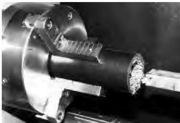
Para mecanizar el I.D. (diámetro interior) de un tubo con pared delgada, se debe mecanizar el O.D. (diámetro exterior) con unas pasadas de desbaste, se debe apretar el tubo suavemente con unas mordazas largas y mecanizar el I.D. con acabado fino. Las mordazas largas agarrarán al tubo sin deformarlo.
