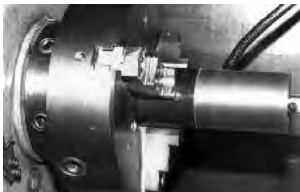
Un cojinete que se fabrica como parte de un tubo se puede sujetar por uno de sus extremos en un plato normal de 3 mordazas, mecanizando aproximadamente el diámetro exterior primero, seguido del mecanizado de acabado del diámetro interior, luego mecanizado de acabado del diámetro exterior y finalmente cortado a la longitud deseada. Se debe poner mucho cuidado en no apretar demasiado las mordazas para no deformar el tubo.
