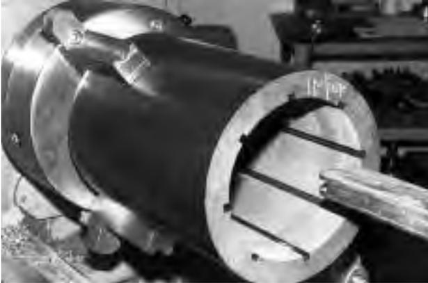
Las ranuras para lubricación pueden ser mecanizadas manualmente o con un ranurador.
