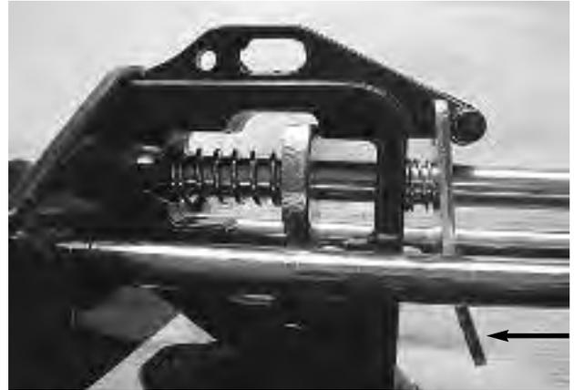
Figura 3: Leva de soltar – indicado con flecha
