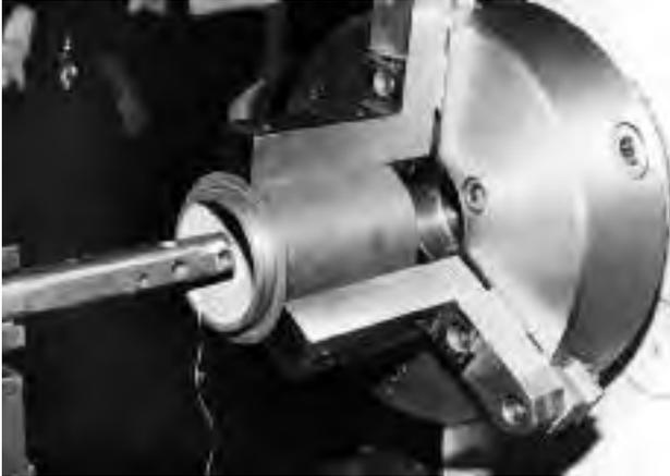
También se puede mecanizar el I.D. de un tubo con pared delgada mecanizando primero el O.D. a la medida correcta, introduciendo el cojinete suavemente a presión en un alojamiento de metal ya mecanizado, apretando el alojamiento en el plato y luego mecanizando el I.D. del tubo. De esta manera es posible obtener tolerancias más ajustadas que las obtenidas por el método de mordazas de apriete suave, pero éste método es más laborioso y usualmente no es necesario.
